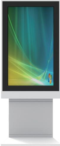
Helios 모델은 표준화된 1.6mm CR강 재질과 분체 및 액상도장을 선택 할 수 있으며 세련되고 품격있는 슬림한 디자인의 독립형 키오스크 모델입니다. 전면부에 LED등과 아크릴 악세사리 부착으로 주목도와 심미감을 증폭 시킬 수 있도록 설계된 완성도가 높은 고급 모델입니다. 이 제품은 용도에 따라 여러 사이즈의 모니터를 지원 할 수 있으며 내부는 슬림PC를 넣을 수 있는 내부 공간 설계가 특징입니다.
